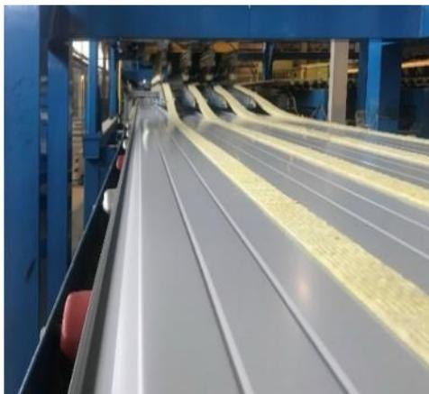
Полностью автоматизированный узел подготовки, смешения и нанесения двухкомпонентного полиуретанового клея нового поколения (производства BASF, Bayer, Hansmann и др.).
