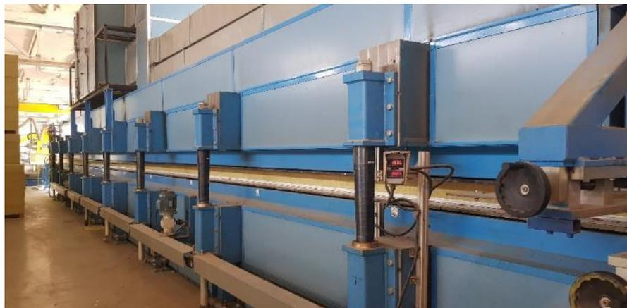
Непрерывный подогреваемый гусеничный пресс, длиной 21 м. Оборудован системой контроля температуры. Обеспечивает полную полимеризацию клея, что обеспечивает безупречную геометрию готовой сэндвич-панели.
