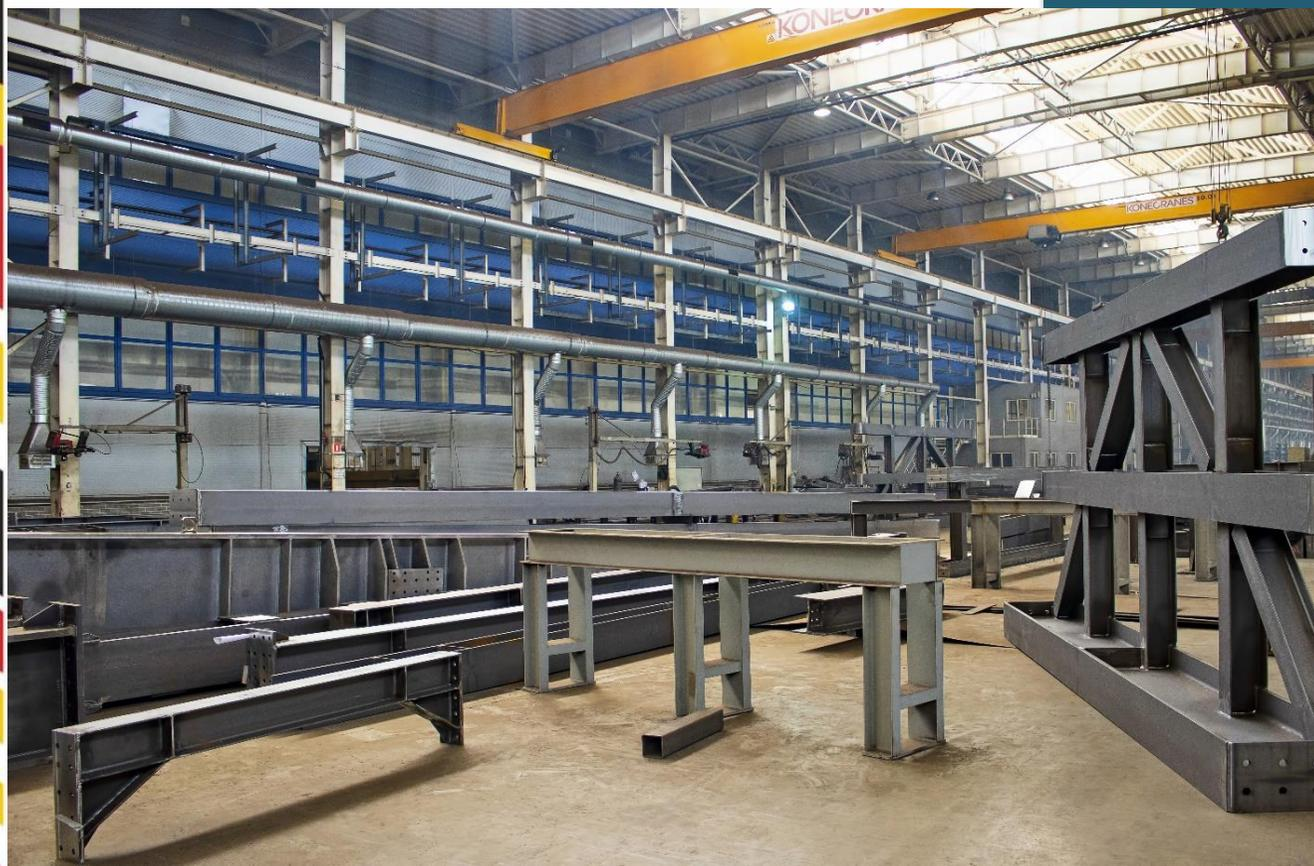
Все заводские соединения стропильных и подстропильных ферм — сварные
