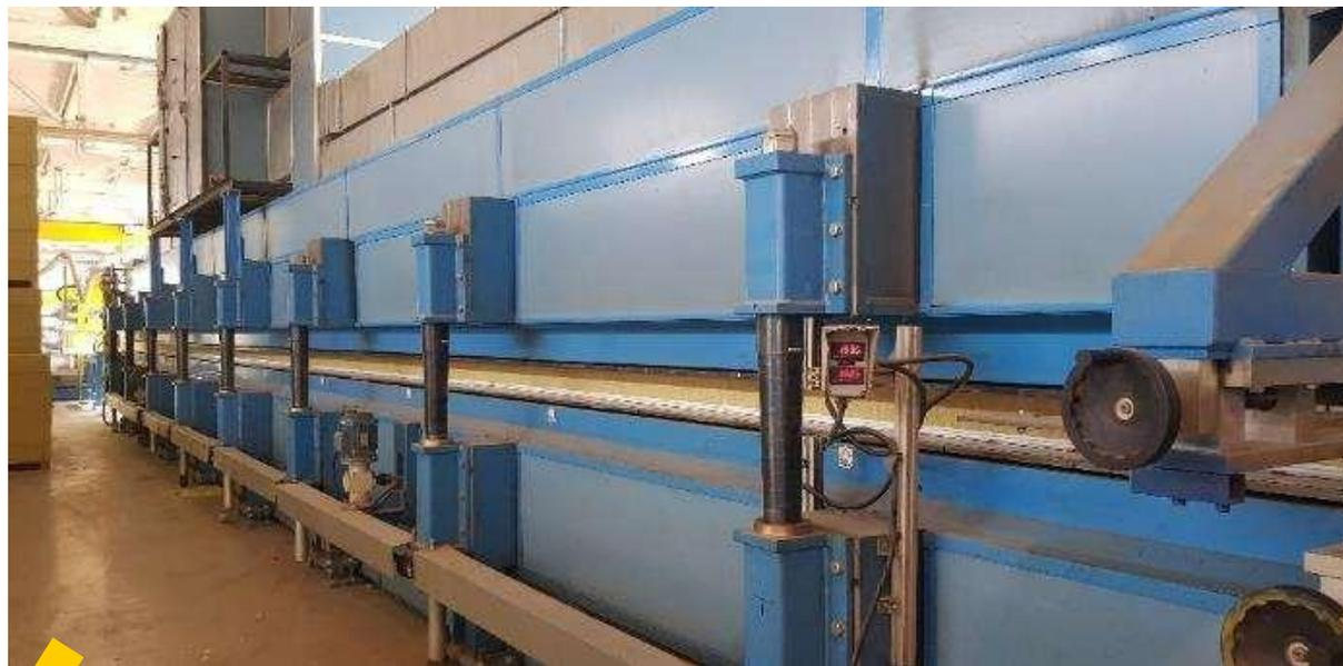
Непрерывный подогреваемый гусеничный пресс, длиной 21 м. Оборудован системой контроля температуры.
