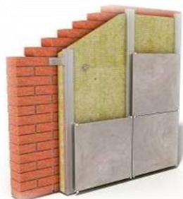
Играет ключевую роль в тепловой защите и звукоизоляции объекта. Состоит из одного или двух слоев.
