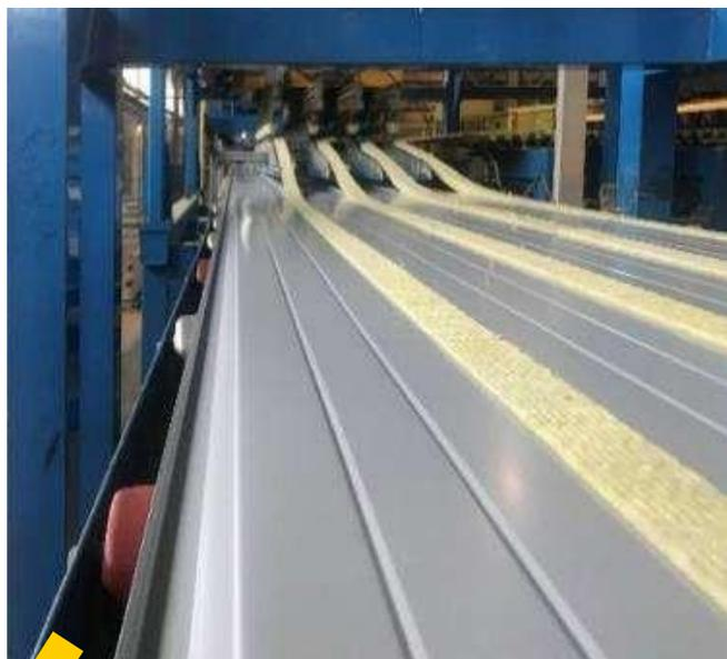
Полностью автоматизированный узел подготовки, смешения и нанесения двухкомпонентного полиуретанового клея нового поколения.
